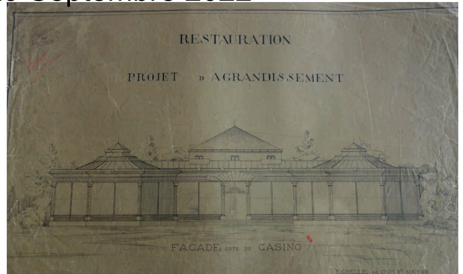
Elévation de la façade ouest, projet de modifications en 1900. La façade vitrée et sa marquise viennent s'harmoniser avec la nouvelle façade du Casino tout proche. [Médiathèque Valéry Larbaud - Vichy]
